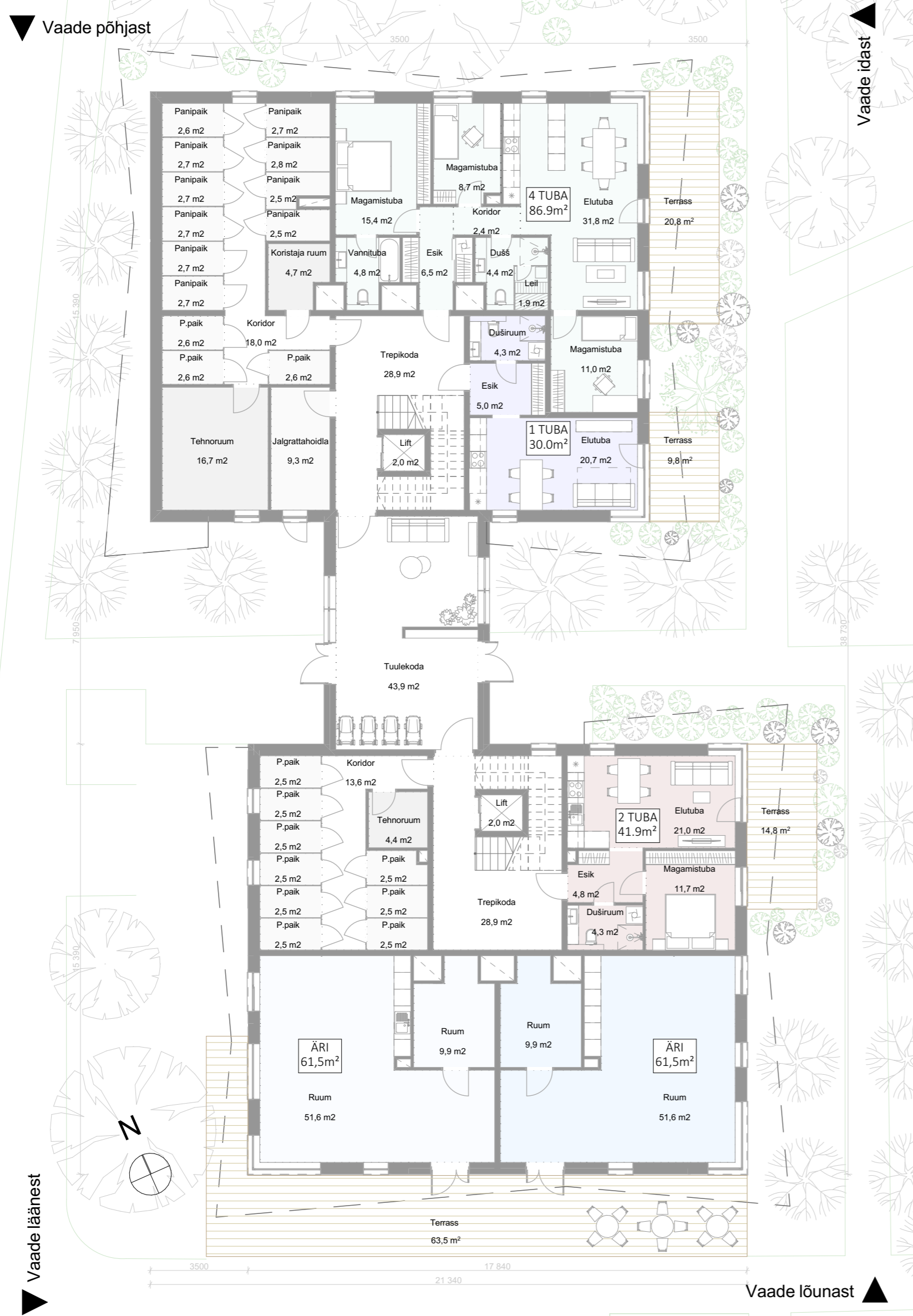
eskadrilli 2 esimese korruse plaan 1:150
