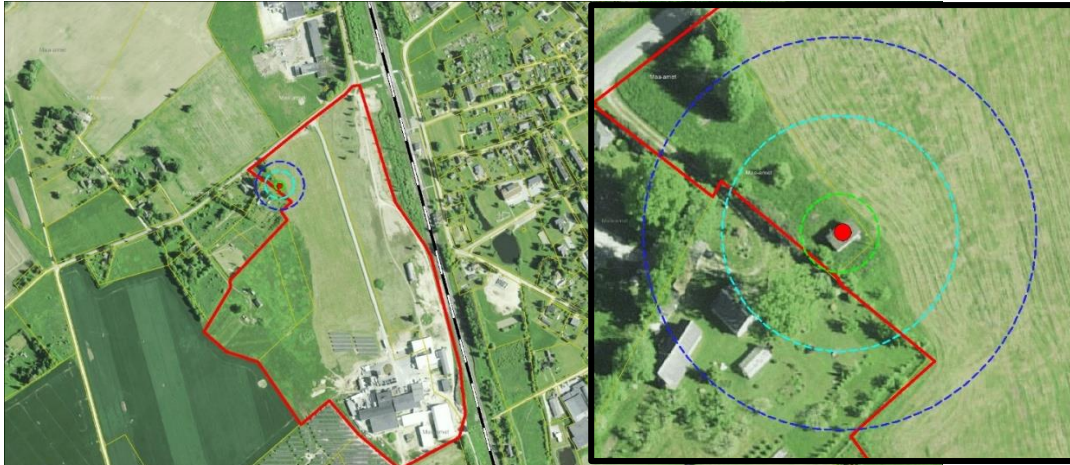
Joonis 3.1. EELISesse kandmata puurkaev DP kava piiril (Voldi tee 11 kinnistul). Tumesinisega on tähistatud 50 m raadius, helesinisega 30 m raadius, rohelisega 10 m raadius. Aluskaart: Maa-amet, 2022.
